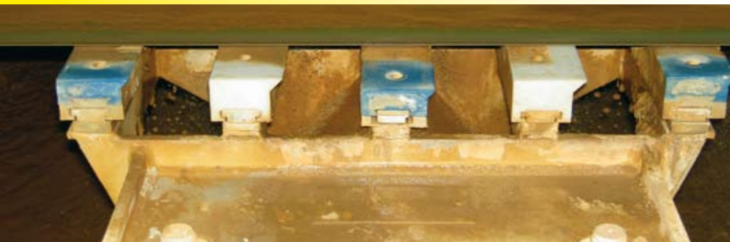
Foils en CeramX que trabajan simultáneamente con foils 100 % cerámica.
